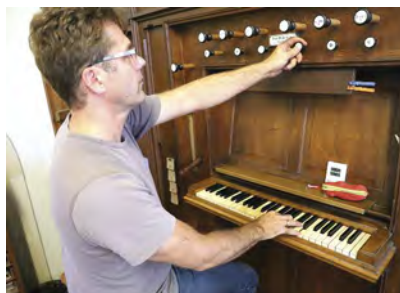
Am Spieltisch der mehr als 125 Jahre alten Orgel überprüft Orgelbaumeister Stefan Reider die Funktion von Registern, Tasten und Pedalen.
