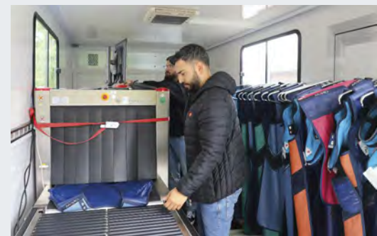
Wie am Flughafen: Die Strahlenschutzkleidung wird im Prüfmobil der Firma RayMedix durch eine Röntgenröhre geschickt und auf Defekte untersucht.
