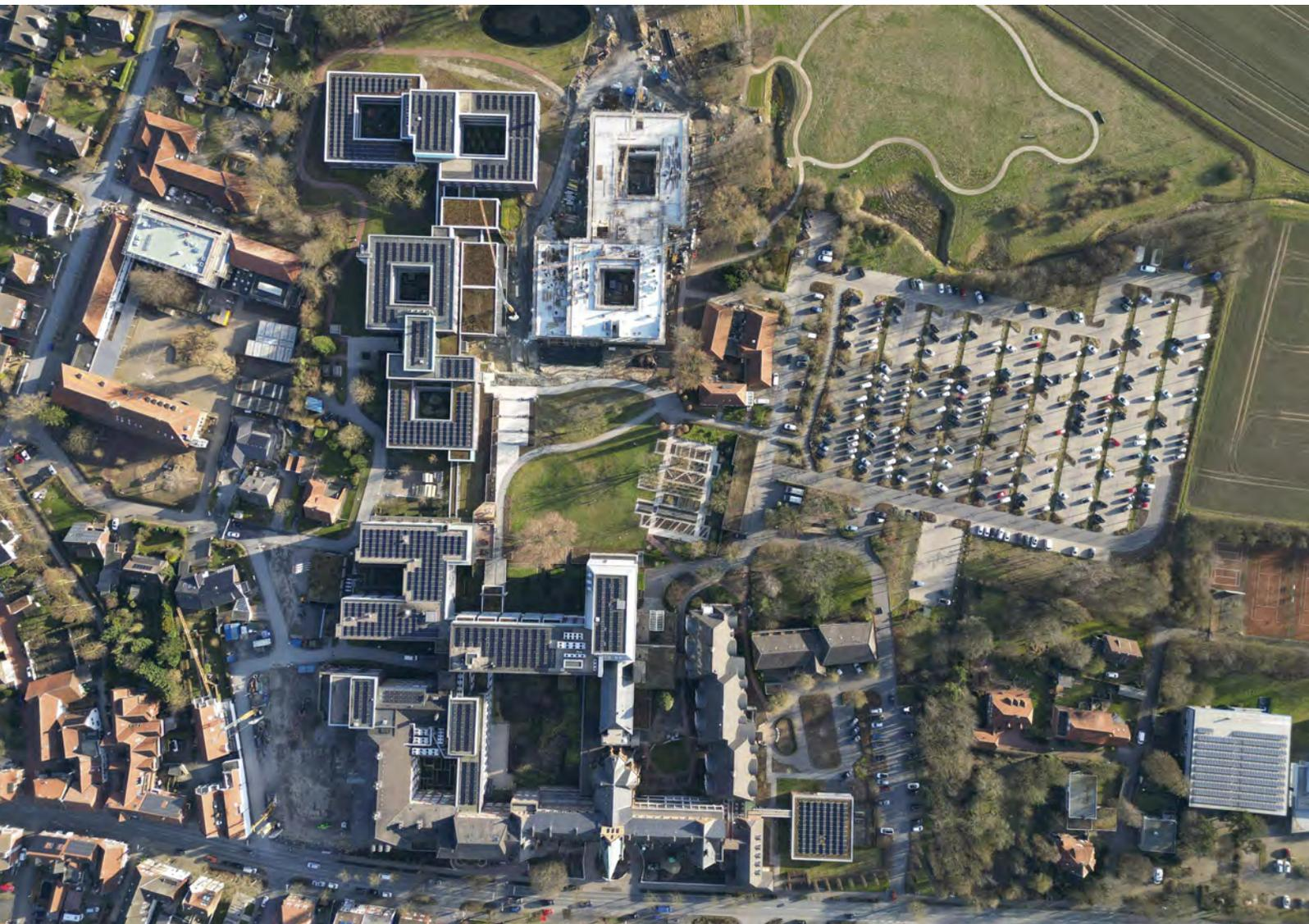
Von oben sind die zwei Atriumgebäude von Reha C gut erkennbar. Der Rohbau geht hier auf die Zielgerade. Zwischen Reha A und Reha C entsteht jetzt der Lückenschluss mit dem neuen Eingangsportal.
